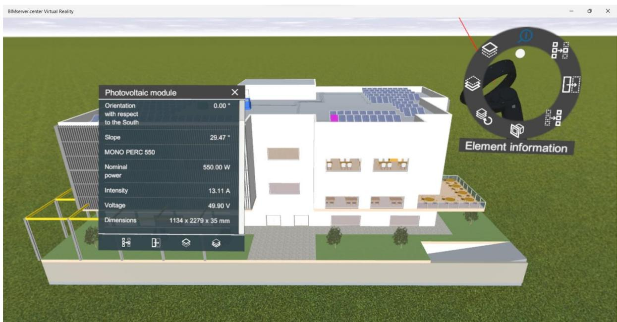
En la imagen se muestra la información BIM de un módulo fotovoltaico del proyecto, haciendo uso de la herramienta descrita.
